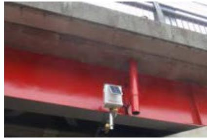
今年度、これまで水位計が未設置となっていた22箇所の重要水防箇所で、洪水時の水位観測に特化した危機管理型水位計を設置。
